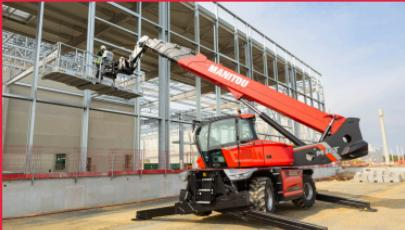
Pristup sa sve 4 strane stroja - uz Easy step ulaz i pristup stroju sa sve četiri strane operateri ne moraju brinuti o poziciji kabine prilikom ulaska
